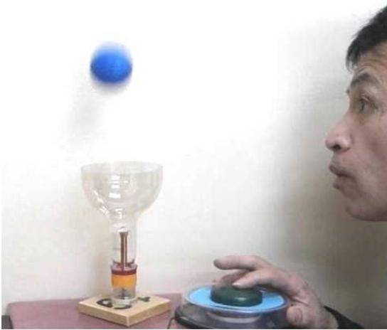
「ジャンピンポン」本体とリレーボックス（瞬間電流型20VDCパワーサプライ）をつなぐ。触ればON、離せばOFFになるようなスイッチならなんでもよい。遊んでみよう。軽くスイッチに触れたとたん、バチッという音をたててピンポン球が飛び上がる。釘の頭のハンマーはピンポン球を蹴り上げたと同時にコトリと下に下がる。もう一度触れるとまた、バチッ。ただ、それだけのことなのだが面白い。スイッチの操作とピンポン球の動きの対比に、ついつい引き込まれる。
