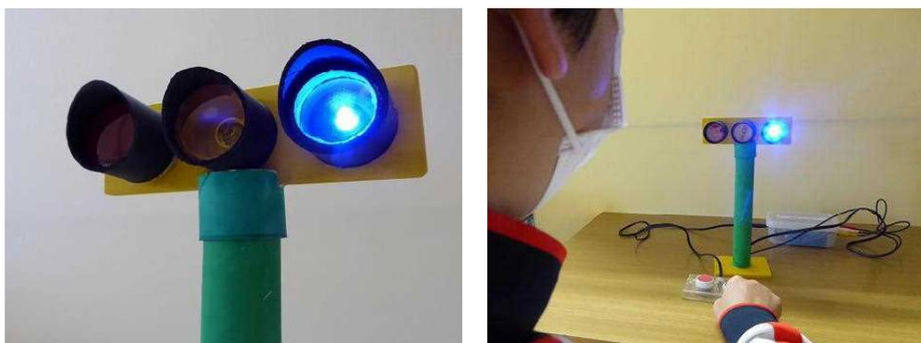
以前、大きな扉が開閉する教材を作ったところ、子供達がとても関心をもち、楽しく学習できた。重い障がいがあっても、日常生活でよく目にしている物が教材になると気持ちを引きつけられるんだなと思った。そこで、毎日、車で通学している子供が目にしているであろう信号機はどうかと、2 匹目のドジョウを狙った教材がこのリアルシグナルだ。ラップの芯と豆電球を材料にして本物そっくりに仕上げている。が、赤 青 黄の順に自動点灯するわけではない。スイッチの操作で赤、青、黄のランプを点灯させることができるという、ただそれだけのシンプルな玩具だ。特徴として2つのランプが同時につくことがない仕組みになっている。
