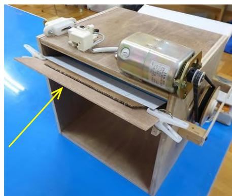
ストッパーは図のようにA B Cの3枚の板で構成されている。Aは先端部の反りを加工できるよう工作用紙で作った。Bは薄手の段ボールで厚さは2mm。このBによって折り目の入る位置が変わってくる。Cは頑丈さが必要なのでベニヤ板で作っている。角度は25度にした。先端はやすりで磨いて鋭利にすることで紙を飲み込むポイントに近づけるようにしている。「ストッパーがストレスなく紙を飲み込み、進行を止めているか。」これをメンテナンス窓を覗きながら確認して位置決めをする。微調整できるようにマグネットシートや洗濯ばさみを使っている。
