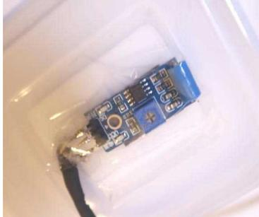
組み込む前に動作を確認する。組み込む容器に合わせて配線の長さなど工夫してコンパクトに収まるようにしたい。電池が4本あるので場所をとるので場所をとる。電池の固定は両面テープで済みます。
