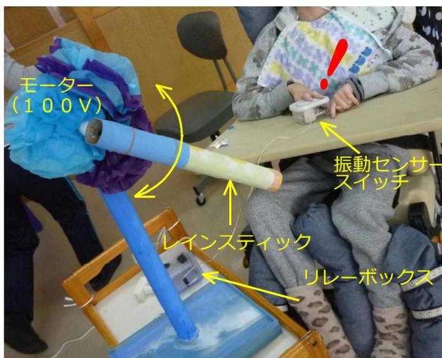
子を操作することが難しい。そこで、振動センサースイッチを使用することを試みた。振動センサースイッチなら何かしらのアクションがあればスイッチを入れることが可能だ。ただし、モーターは家庭用100ボルトの電源なので振動センサーとモーターの間には「リレーボックス」を接続して使用する。
