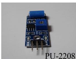
人の動きに伴う振動を感知して「オン」になるスイッチも作る。そのために見つけ出したのは、PU-2208 という型番の振動センサーモジュールだ。このモジュールは5ボルト程度の電源を与えると、振動を感知したときに電源と同程度の電圧を発生して教えてくれる。残念ながらこちらは感度を調節したり、電圧を発生し続ける時間の長さは調節することはできない。振動を感知した瞬間のみ電圧を発生する。そのかわり、通電中は赤いLEDが点灯する。つまり、パイロットランプ付きである。このモジュールも非常に安く、110円で手に入った。このモジュールには振動感知後しばらく「オン」の状態を維持するためのタイマーを付けたうえでリレーを動作させることができればスイッチとして使えそうだ。振動センサースイッチと名付けることにする。
