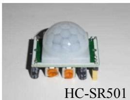
人の体温を感知して「オン」になるスイッチを作る。そのために見つけ出したのは、HC-SR501 という型番の赤外線センサーモジュールだ。このモジュールは、9ボルト程度の電源を与えると、人の体温を感知したときに5ボルトの電圧を発生して教えてくれる。また、体温感知の感度を調節したり、5ボルトの電圧を発生し続ける時間の長さも調節することができる。このモジュールの価格はネットショップによって違っていたが、定価の95%オフという驚異的な価格が付いているネットショップがあり、一個145円という安さだった。このモジュールを使い、感知した時に発生した電圧でリレーを動作させることができればスイッチとして使えそうだ。赤外線センサースイッチと名付けることにする。
